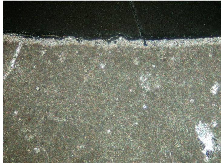
Microfoto a luce polarizzata trasmessa del campione 21 (33X - nicols incrociati)
